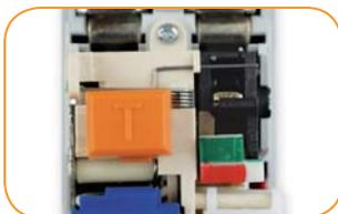
Электромеханическая схема без электронных компонентов. Не имеет собственного потребления электроэнергии и сохраняет работоспособность при обрыве нулевого проводника
