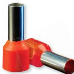
Зачищенный конец многожильного провода заводится внутрь полой концевой трубки и затем опрессовывается вместе с трубкой при помощи специального инструмента - клещей обжимных КО. Таким образом, возникает единая конструкция, надёжно фиксирующая пучок многопроволочной жилы
