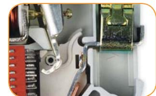
Наплавка из серебросодержащего композита повышает износостойкость и снижает переходное сопротивление контактной группы
