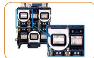
Использование двух трансформаторов на каждом полюсе. Первый трансформатор линейный, отвечающий за контроль текущего сигнала. Он обеспечивает высокий класс точности во всем диапазоне токов КЗ. Второй трансформатор предназначен для питания электронного расцепителя
