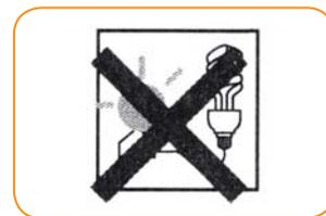
Не использовать лампу с регуляторами света, электронными стартерами, фотоэлементами, реле времени и световыми датчиками – это сократит срок службы лампы
