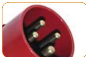
Штыревые контакты изготовлены из электротехнической латуни, розеточные узлы – из фосфористой бронзы. Для защиты от коррозии все элементы покрыты никелем
