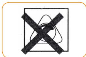
Категорически нельзя ронять лампу или подвергать ее механическим нагрузкам
